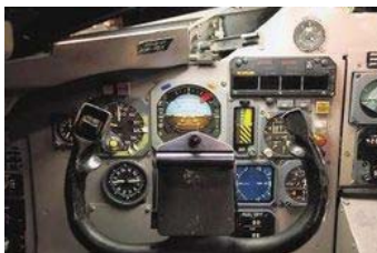
Das echte Cockpit der MD 83, die noch Steuerknüppel statt Joystick hat. (Foto: PD)
