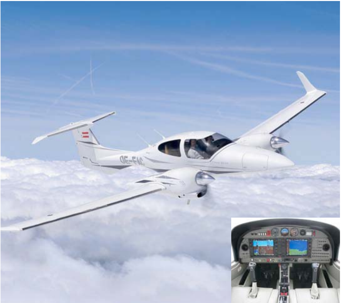
Die Diamond Aircraft DA42 ist ein neues Flugzeug, das von zwei Dieselmotoren angetrieben wird. Fotos: zvg
